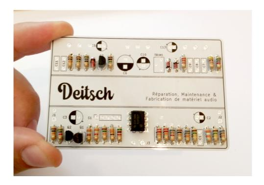
8. Insérez les condensateurs non polarisés (C1, C7, C8, C9, C11, C12), soudez-les puis coupez les pâtes.
