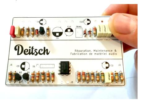
9. Insérez les condensateurs polarisés, soudez-les <u>en faisant bien attention au sens</u> <u>de montage</u> puis coupez les pâtes.
