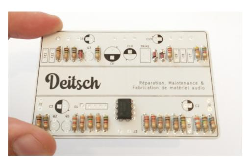
7. Insérez les transistors dans leurs emplacements <u>en faisant bien attention au</u> <u>sens de montage</u>, soudez-les puis coupez les pâtes.
