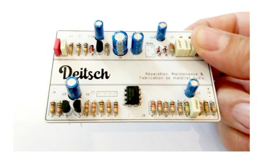
10. Insérez le trimmer dans son emplacement, puis soudez-le au circuit.
